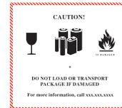
Beispiele für Kennzeichnungen von Sendungen mit Lithium-Batterien (\* = Platzhalter für jeweils zutreffende Bezeichnung „Lithium-Metall-Batterien / lithium metal batteries“ und/oder „Lithium-Ionen-Batterien / lithium ion batteries“)
